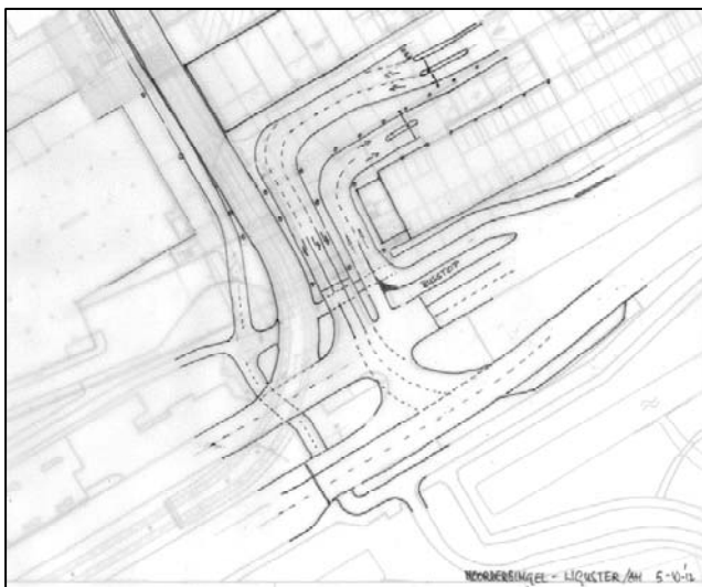
Figuur 3.6: Handschets van de oplossing van de parkeerlocatie zuid op de Noordsingel
