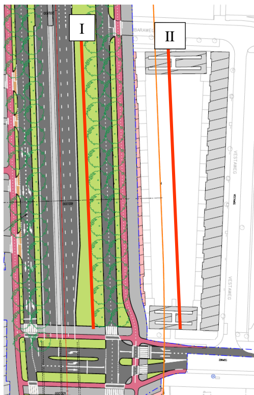
Figuur 4 Twee mogelijkheden voor de locatie van een scherm
