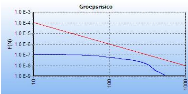
Figuur 5.1 FN curve voor W-536-01 van N.V. Nederlandse Gasunie voor de kilometer tussen stationing 1800.00 en stationing 2800.00
