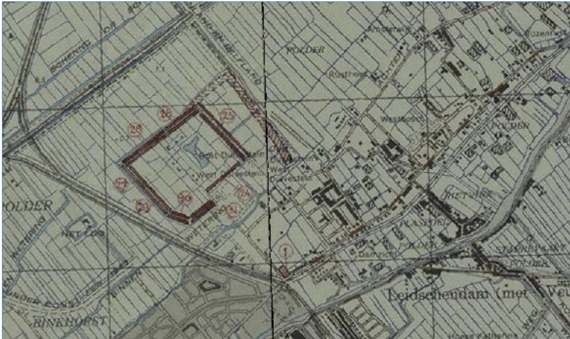
Afb.16.- Voorbeeld van een originele mijnenkaart waarop rood gearceerd mijnevelden en op mijnen verdachte gebieden staan aangegeven. Bron afbeelding: EOD.
