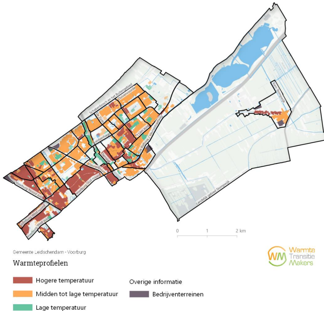
Figuur 9. Warmteprofiel gemeente Leidschendam-Voorburg: de afgifte-temperatuur die nodig is nadat alle rendabele isolatiestappen gezet zijn. We geven clusters weer van huizen met een zelfde warmteprofiel. Individuele huizen zijn niet in kaart gebracht.
